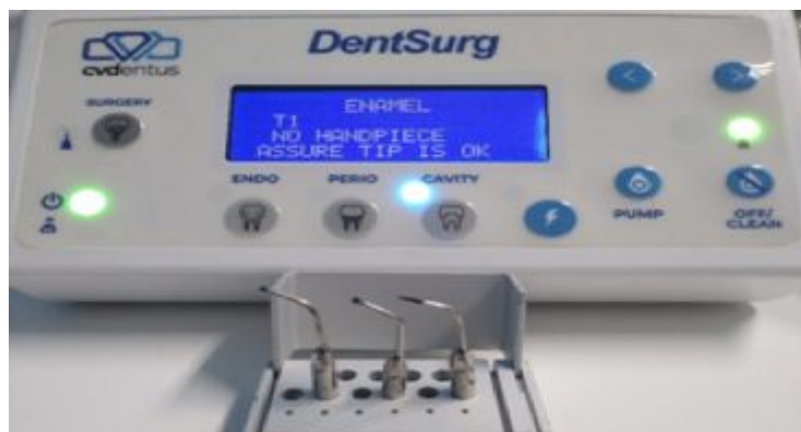
Figura 1 - O DentSurg da CVDentus possui muitas opções de pontas diamantadas (no exemplo apenas 3 são mostradas) para diversas aplicações clínicas.
